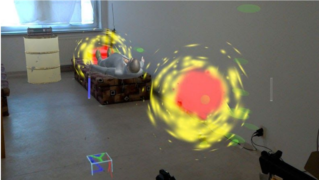
Fig. 9. Visión de campos de radiación (partículas rojas y amarillas), elementos virtuales (cadáver, barril con una bomba encima, en el fondo) y partículas de contaminación en la pared derecha y en el suelo a través de un Hololens. Barra azul de oxígeno remanente en el tanque, a la izquierda, y colorada, de dosis de radiación acumulada, a la derecha (vacía, al momento de la captura). Punto de calibración en el suelo.
