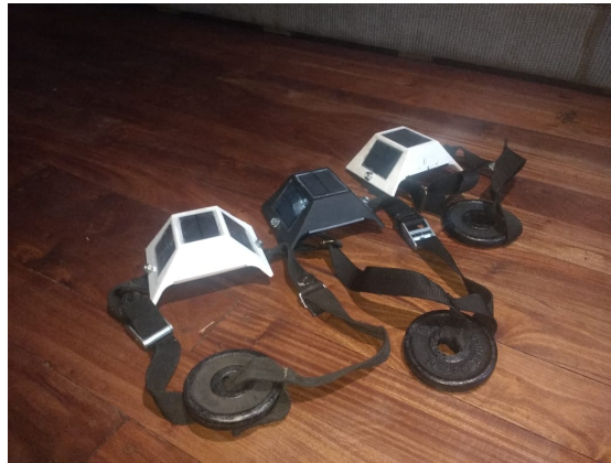
Figura 1: Collares con carcasa, panel solar y contrapeso
